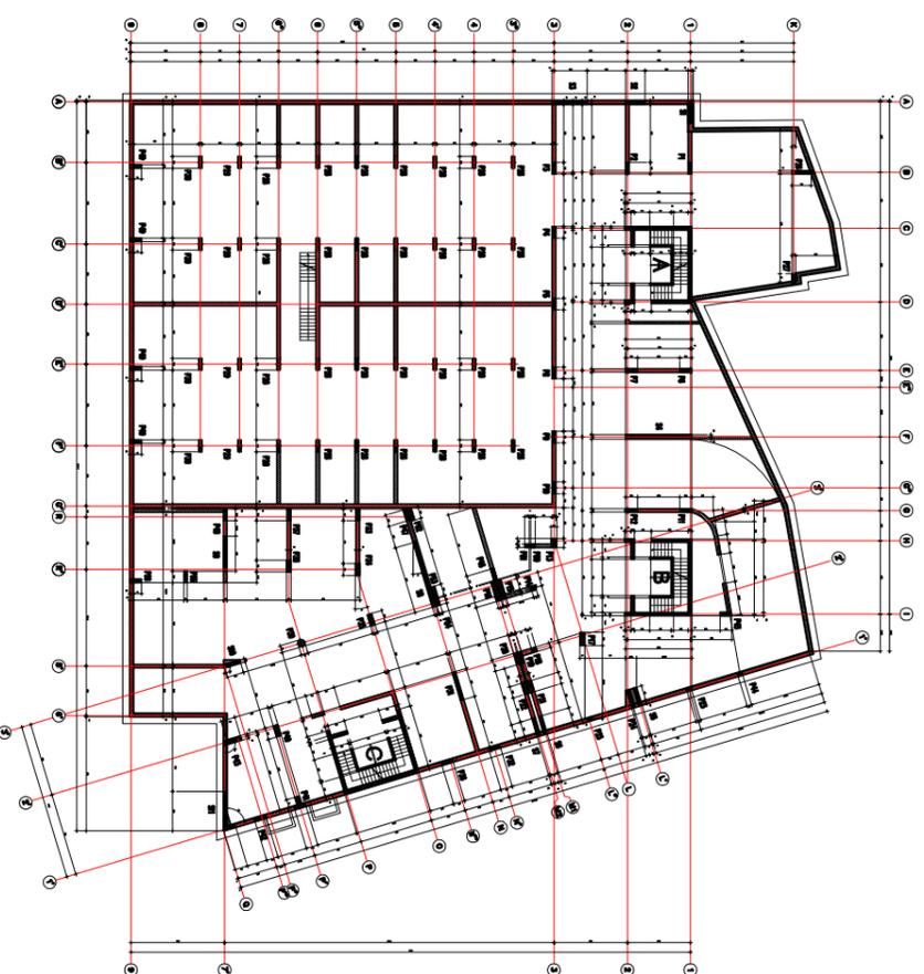
SCHEMA SETTI E PILASTRI PIANO INTERRATO
